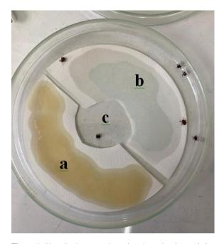
Figura 1. Placa Petri que contiene ejemplares de Rhipicephalus sanguineus y los dos trozos de papel filtro impregnados; uno con uno de los extractos en estudio (a) y el otro impregnado con el aceite de maravilla (b), como control negativo. Al centro (c) se observa sector sin papel filtro, donde se depositaron 6 garrapatas.
