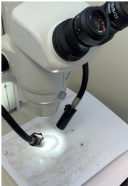
Figura 2: Lectura con hallazgo y posterior identificación taxonómica mediante observación microscópica (Microscopio estereoscópico Nikon SMZ 745T)
